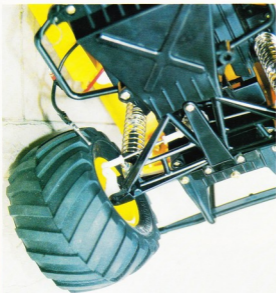
Le châssis baïgeoire en ABS prend appui sur le pont avant oscillant mais également sur un train avant bénéficiant de triangles intérieurs indépendants.
