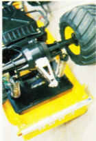
Le châssis baïgeoire en ABS prend appui sur le pont avant oscillant mais également sur un train avant bénéficiant de triangles intérieurs indépendants.
